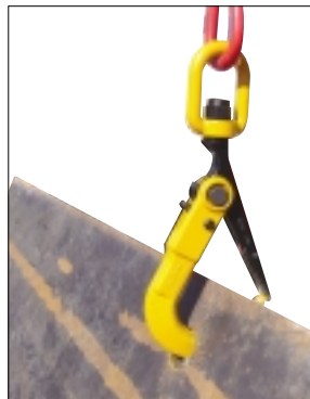
敷鉄板の敷設・撤去作業
